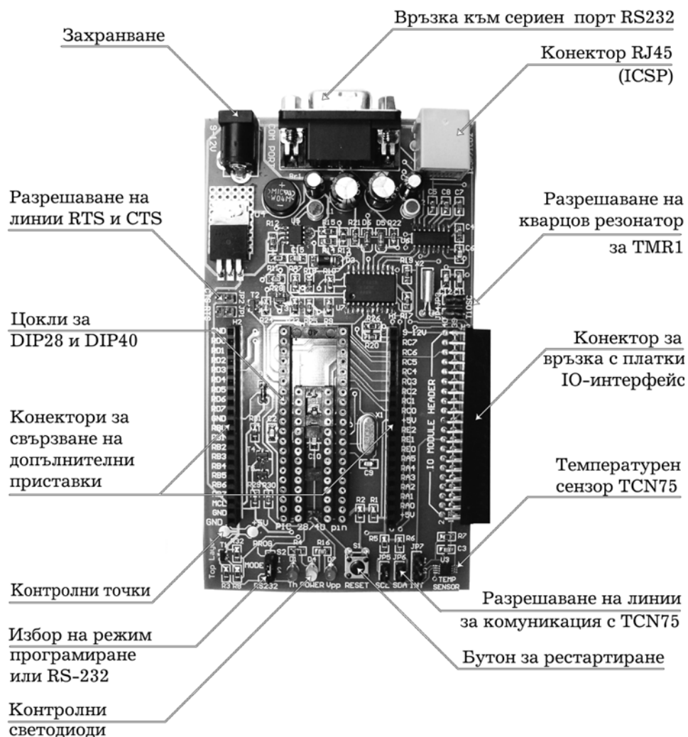
Фиг. 1. Общ изглед на развойна платка PICtest 1.0.
